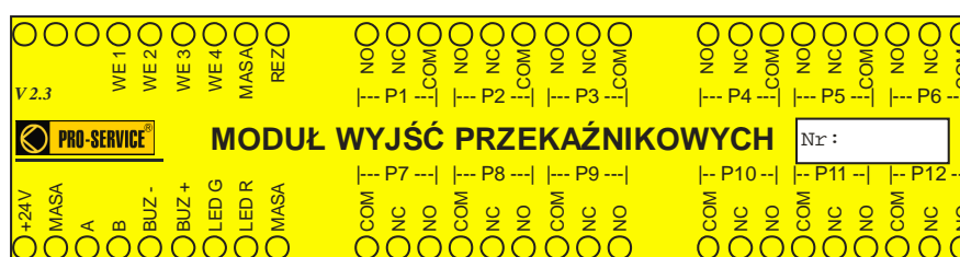
Rys. 6. – Płyta czołowa modułu wyjść przekaźnikowych centrali modularPAG®.
